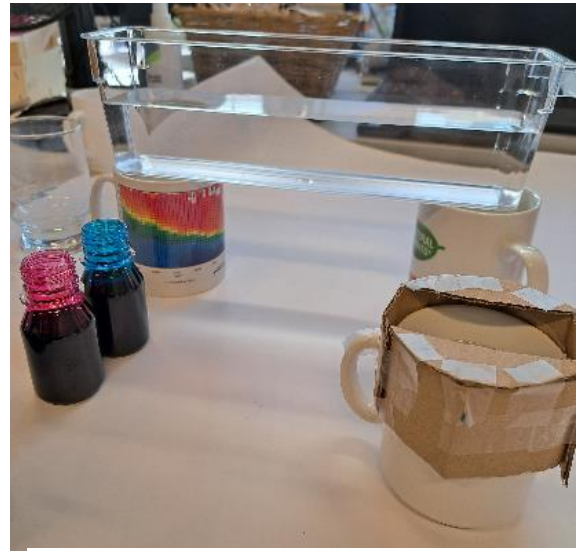
Abbildung 13 Aufbau: ein Wasserbehälter steht auf zwei Bechern
